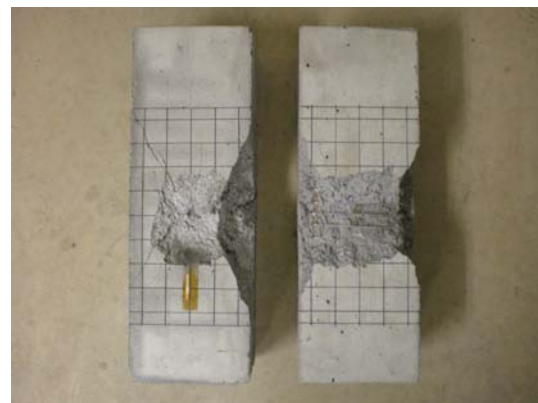
Fig. 1 コンクリート柱の高速衝突破壊性状
