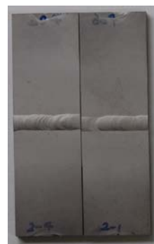
図1. ピーニング済溶接試験片
