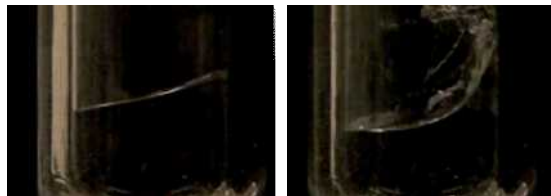
(a) 小振幅 (b) 大振幅(スワール・碎波)
