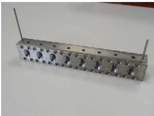
図2 定量的な散乱計測を行うための多連 セル。図中のセルには8個の独立したほぼ等 価な観測ポートが設置されている。
