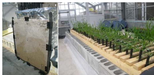
第1図. 試験で用いた根箱と試験期間中の様子。各根箱の▼の位置に播種を行った。コンクリートブロック、ビニルシートおよび木枠を用いて、根箱を静置した。
