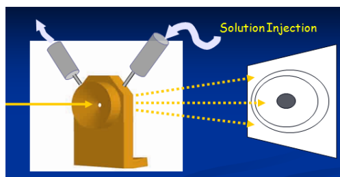
図 1 溶液環境制御セルの概略図
