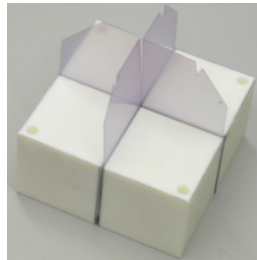
図5 フィルム装填用水等価固体ファントム 3次元動体ファントム上にフィルムを装填した水等価固体ファントムを配置し、呼吸性移動を再現した。フィルム中心部に対して150 cGy 照射するための治療計画を作成した。治療計画装置から出力した計算線量プロファイルおよび計算線量分布に対して、フィルムを用いて実測した線量プロファイルおよび線量分布の比較を行った。
