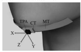
下顎運動は超小型3軸加速度センサーを下 顎に貼付する方法を開発した。貼付方法を上 図に示した。
