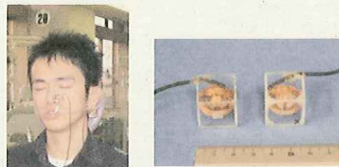
図1 CS-IIiを用いた顎運動測定風景とセンサコイル
