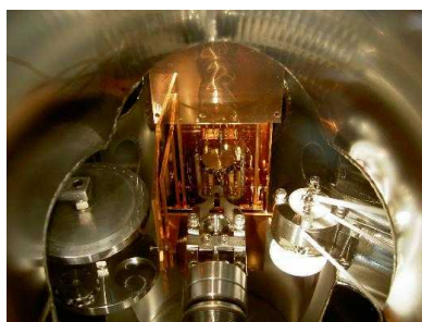
図1: スキャナ(中央)電子ビームヒータ(右側)試料/探針保持用カラムセル(左)
