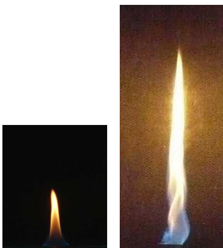
(a) 旋回無 (b) 旋回有 図 2 液体プール火炎と旋回流との相互作用
