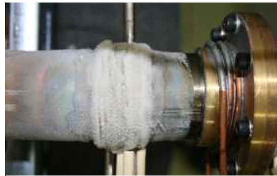
Fig. 3. 加圧気体を作動流体とする進行波型熱音響冷凍機の写真。(上) 全体、(下)蓄熱器付近、霜が付いている所が熱交換器。
