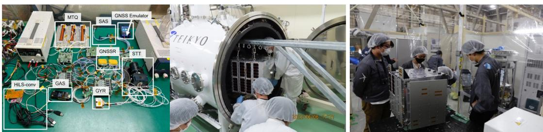
図6：衛星制御回路群（左）、熱構造モデルの熱真空試験（中）、熱構造モデルの振動試験（右）
