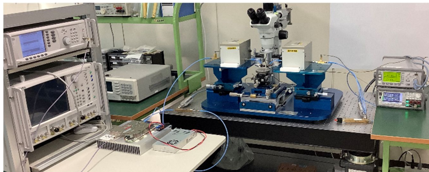
図 8 構築した準ミリ波帯ロードプル評価システム
