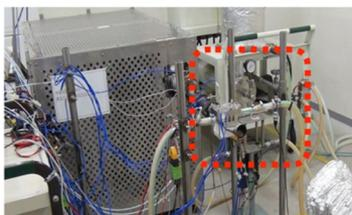
図 5: VCHP 熱交換器エンジン排気ガスをシミュレートする温風発生装置での試験の様子 (赤枠部が製作機器、左部が熱風発生機)
