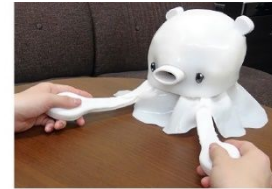
柔らかさ可変 エージェント
