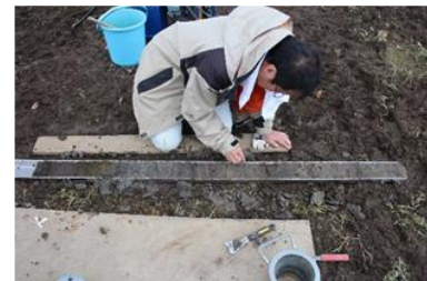
写真2 ジオ・スライサーによる土壌・珪酸体試料の採取
