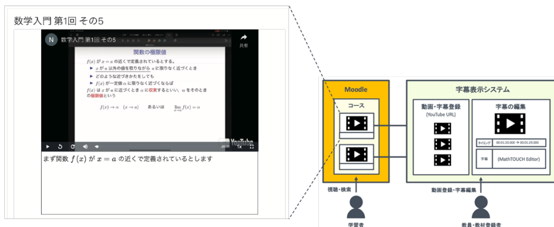
図 6: 数式に対応した講義動画字幕表示・編集・検索システムの概要図
