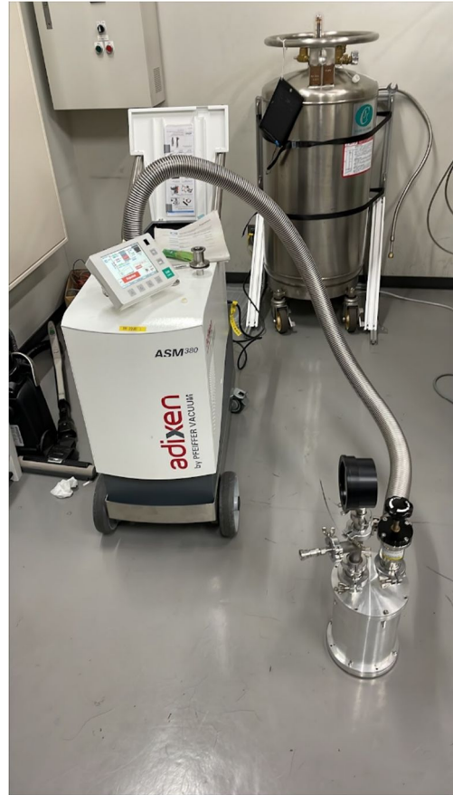
図 4: シール材からのヘリウムの放出量を測定するためのセットアップ
