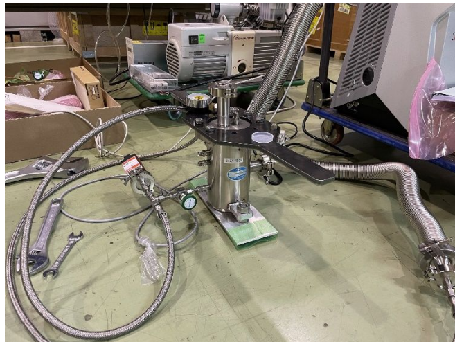
図 2: 作成した回転継手と、その試験中の様子。回転部の上部には黒いハンドルをとりつけ、回転させながらリークの状況を確認した。
