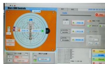
図6. 試料装置部制御ソフトの操作画面。気密蓋を開くためのヒーター加熱、染色液添加のための穿孔操作を行う。また、顕微鏡による撮像を行うために、1-1000 \mu\text{m} 刻みでローターを回転させることができる。
