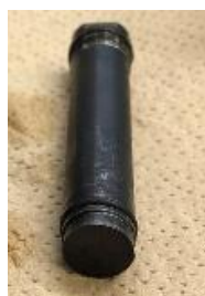
図4. 限外濾過筒。手前の底面にはポリカーボネートフィルターが貼られている。
