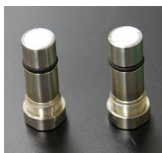
図3. 染色液筒底面。アルミ箔が貼られており、穿孔操作により、染色液を添加する。
