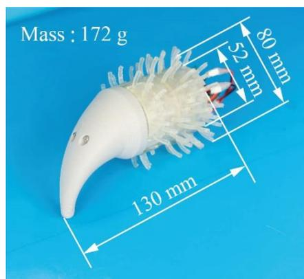
図4 回転頭角を有する配管探索ロボットの全景
