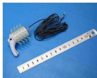
図6 有線式の回転頭角付き配管探索ロボットの全景
