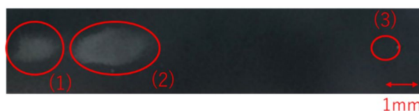
図3 初段加速後のアルミニウムイオンビームに対する磁場偏向型分析器の結果
