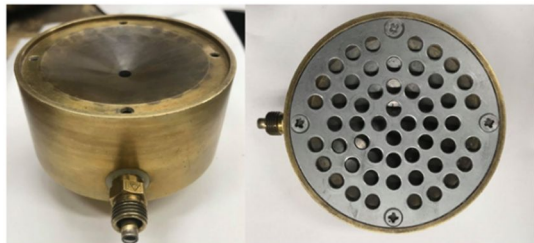
図3 細粒分の抜け出しを許した三軸試験装置の全体概要と特殊な細工を施したペDESTAL
