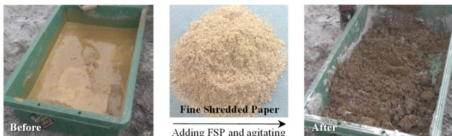
図1 古紙微細粉体（FSP）を用いた高含水処理技術
