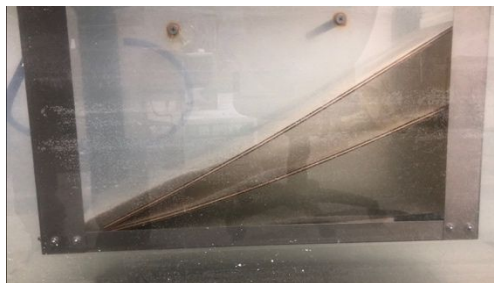
図2 実験の様子．発生した斜面崩壊
