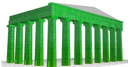
図 4.3.1 3 次元拡張個別要素法による解析モデル
