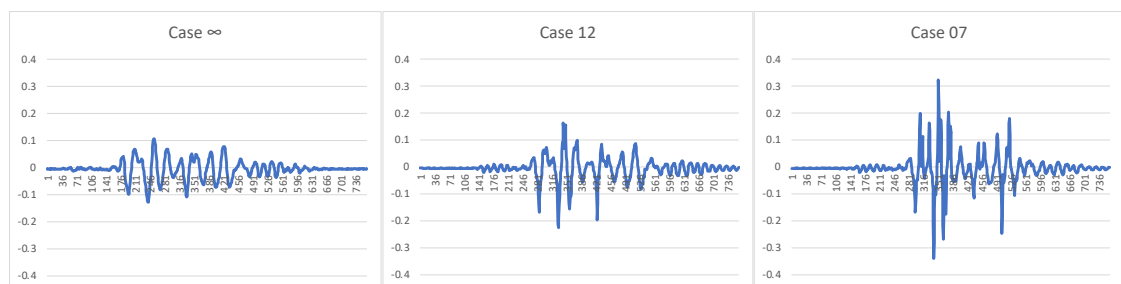
図6 ストロークオーバーが生じない場合(左)と生じた場合(中:許容ストロークは両振幅で12mm,右:許容ストロークは両振幅で5mm)の応答加速度波形
