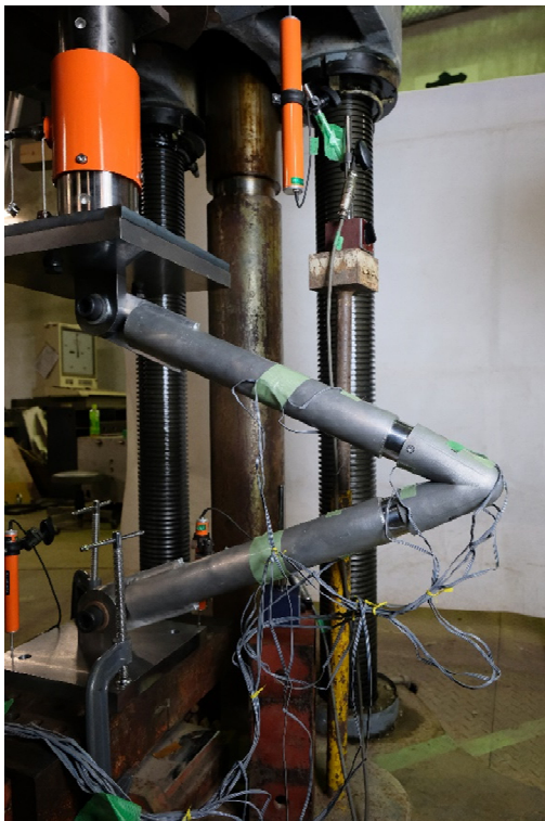
図11 曲げ破壊実験中のAMJ
