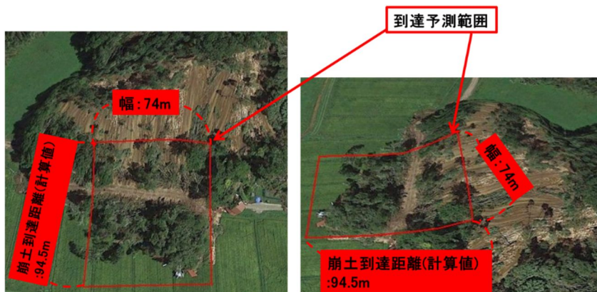
図-4 東和地区における崩土の到達予測範囲 (赤四角の範囲)
