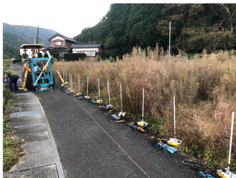
図 3 鹿野断層における S 波反射法地震探査
