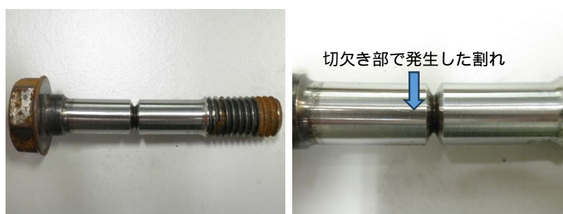
図 2 回収した FS ボルトの外観写真
