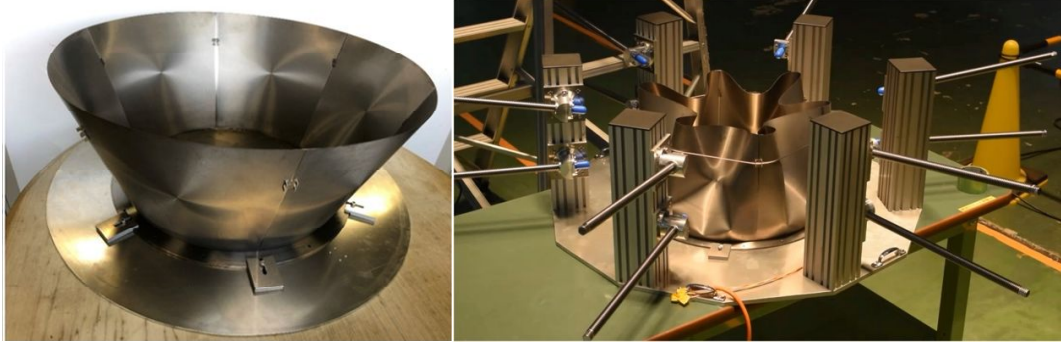
図3 展開ノズル実物大モデル (a)製作後 (b)折り畳み後の収納状態
