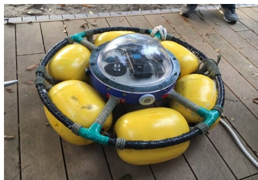
図 4 放射線モニタリング用小型ブイのプロトタイプ
