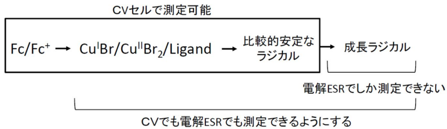
図1 本研究の方針 サイクリックボルタンメトリー(CV)セルで測定可能な酸化還元電位から順に段階を踏んで成長ラジカルの酸化還元電位の測定を目指す 銅錯体や安定なラジカルは CV セルでも電解 ESR セルでも測定可能であるが、成長ラジカルの酸化還元電位は電解 ESR でしか測定できない。
