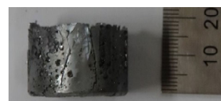
図 9.育成した 1 インチ径 Sn/SnSe 共晶体結晶。
