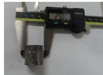
図 8.育成した 1 インチ径 SnSe/SnSe 2 共晶体結晶。
