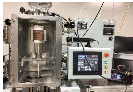
図 4 \mu -PD 炉を用いた VB 法。
