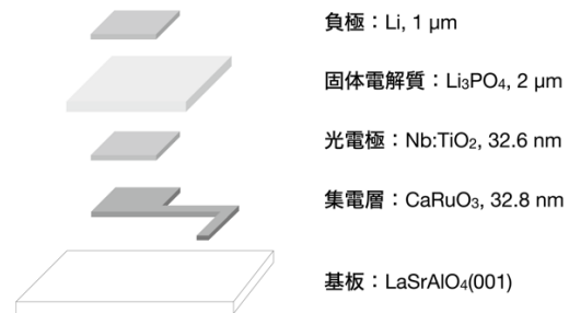
図3 作製した薄膜型全固体電池の概略図。
