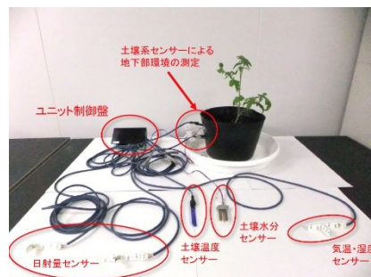
図1. 個体ごとの生育環境データを測定・記録する環境センサーユニット。1個体に対して様々な環境データを取得する。
