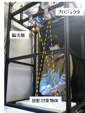
図10：立体表現用の試作装置
