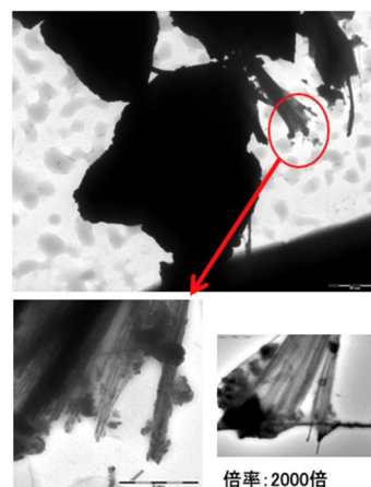
図6、電子顕微鏡によるリザルタイトの観察。繊維状のクリソタイルがわずかに混入していることが判明した。
