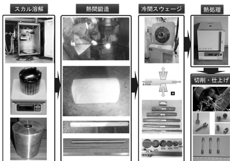
図 1 合金試料製造プロセス
