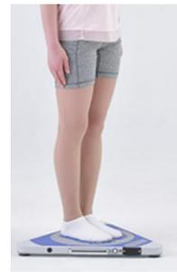
図1：臨床で用いられている姿勢安定性を評価するための重心動揺計
