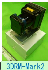
図1 小型・軽量・安価な3次元レーザスキャナ
