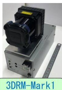
図1 小型・軽量・安価な3次元レーザスキャナ
