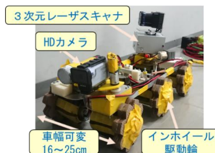
図2 車幅変形型坑道探索ロボット
