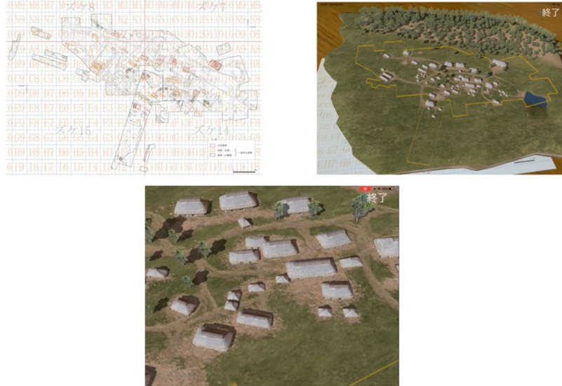
図3 (左上) マーカーとして用いた平面図, (右上) 重畳表示される AR 模型 (下) 端末を図面に近づけた状態
