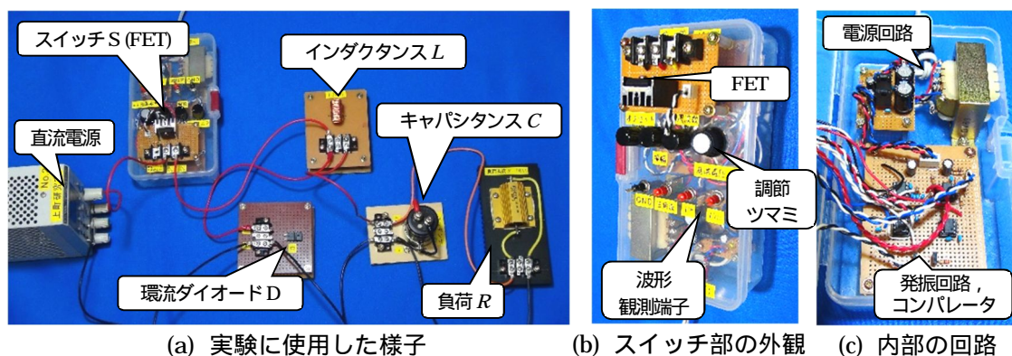
図 9：チョップ回路学習用実験教材
