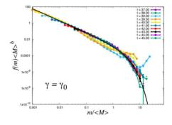
さらに様々な解析を行った結果、この系に対して以下のことが分かった。まず、先行研究で知られているさまざまな普遍性クラスの観点から見ると、この系は二次元バルク系と同じ普遍性クラスに属しており、曲率の効果がはっきりとは現れていない。またこれは三次元球殻系の衝撃破壊とは明らかに異なる普遍性クラスに属しており、準静的破壊が曲率の効果を打ち消し二次元のバルク系と同じ状況を生み出していると思われる。この結果、より定量的に普遍性クラスの移り変わりを調べる必要がある事が分かった。またこの系はさまざまな実在系に適用可能であり、この観点からも更なる研究が必要である。
