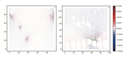
のものは開放される応力が左の状況と比較して大きいことがわかった。これらの振る舞いは系 の巨視的な振る舞いにも表れ、歪み応力曲線においては、左では非線形ではあるがなめらかな応 力挙動を示し、右では不連続な応力挙動を示すことが分かった。
