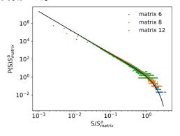
理論を参考に定義した亀裂成長ながさと応力降下の間の統計則にある。基本的には、亀裂成長ながさと応力降下量には正の相関がある。ここで亀裂成長ながさが長く応力降下量が大きい領域で、べき的な依存性が見つかった。さらにこの依存性は内部構造の特徴的な長さスケールに依存しており、その依存性が界面粗さ指数をつかったスケーリングで完全に消失することが分かった。本来界面粗さ指数は十分に長い界面に対して定義されるべきものではあるが、この内部構造の特徴的長さスケールは非常に短くそのようなスケーリングが期待できない状況である。そのような状況にもかかわらず界面粗さ指数がでてきたことは非常に興味深く、さらなる研究が必要である。
