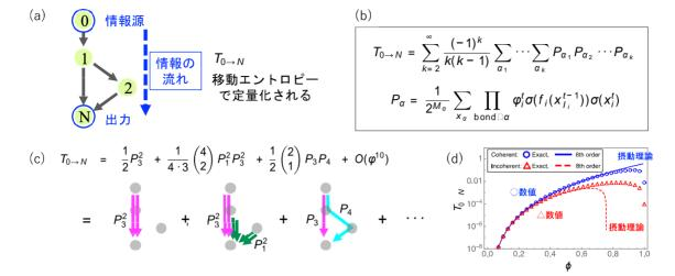
さらに、ブーリアンネットワークネットワーク上の情報の流れが入力シグナルの性質にどのように依存するかを記述する一般公式を導いた。この公式を、ネットワークモチーフ(下図)に適用し、各ネットワークモチーフがもつ情報の流れの特徴を明らかにした。具体的には、ポジティブフィードフォワードモチーフは、高周波の入力シグナルを遮断するローパスフィルターの役割を持ち、ネガティブフィードフォワードモチーフは、低周波を遮断するハイパスフィルターの役割を持つことが明らかになった。さらに、そのようなフィルター機能の起源が、長さの異なる情報経路間の相互作用によって生み出されていることも分かった。一方で、長さの異なる情報経
