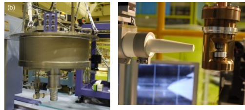
図2.(左) -XYZ軸を備えた高圧セル用冷凍機システム。(右) BN製ノズル式入射コリメータ。
