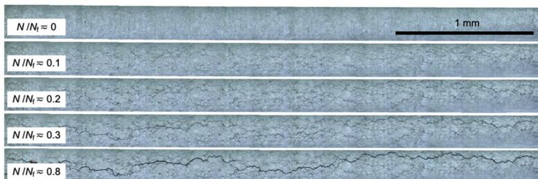
図 3 応力集中部の顕微鏡観察の例
