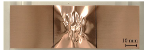
図9 樹脂型利用マイクロバブル活用放電成形後の金属板の写真
