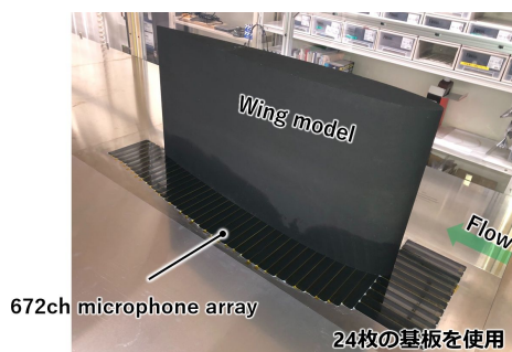
図1 翼・平板結合部 672ch 圧力変動計測 図2 フレキシブルマイクロアレイ(上)と60ch 2列マイクロアレイ(下)
